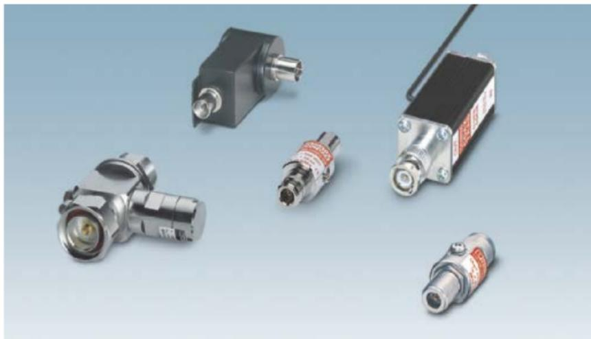
Die hohen Frequenzen der Funkübertragung erfordern Schutzgeräte mit geringer Eigenkapazität beziehungsweise kleiner Einfügungsdämpfung. Dennoch ist eine gute Schutzwirkung mit hohem Ableitvermögen erforderlich. Darum sind die meisten Schutzgeräte mit leistungsstarken gasgefüllten Überspannungsableitern ausgestattet. Alternativ hat sich die Lambda/4-Technologie als Schutz für schmalbandige Signale bewährt.
