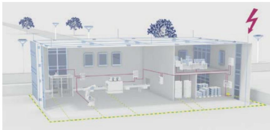
entsteht zusätzlich eine Überspannung. Sie ist aufgrund der großen Stromsteilheit hauptsächlich auf den induktiven Anteil des Leitungswiderstands zurückzuführen. Nach dem Induktionsgesetz kann sie wie folgt berechnet werden:  $U = (-)L \times di/dt$ .
